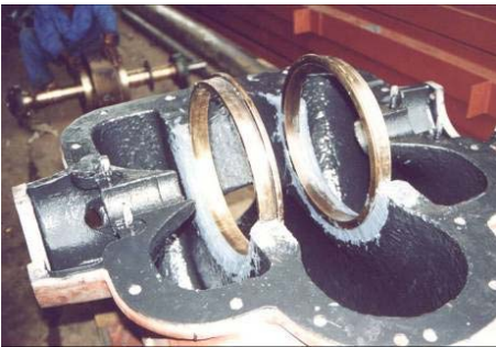
Obnova telesa a obežného kolesa čerpadla
