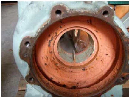
Obnova telesa a obežného kolesa čerpadla
