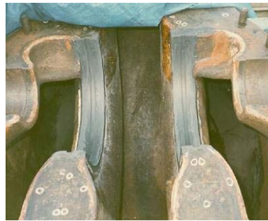
Obnova telesa a obežného kolesa čerpadla
