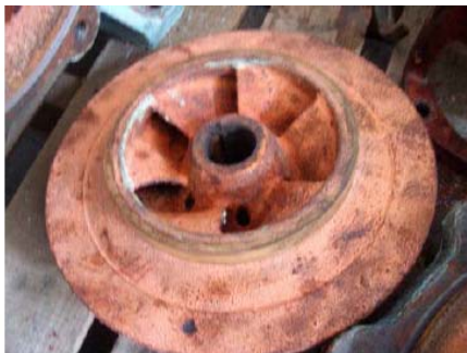
Obnova telesa a obežného kolesa čerpadla
